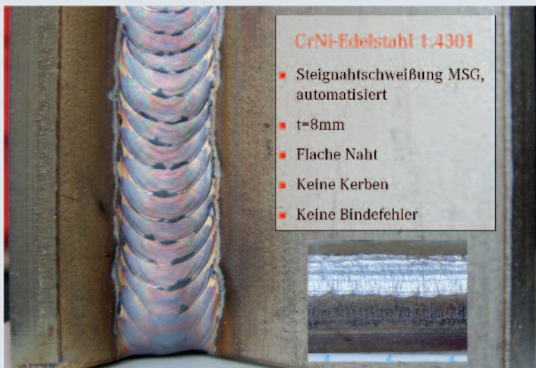
▲ Bild 5. Probe einer automatisierten Steignachtschweißung mit der neuen Verfahrensvariante (Edelstahl X 5 CrNi 18-10 (1.4301), Blechdicke 8 mm, Schutzgas 98% Ar + 2% CO 2 , Drahtelektrode 1.4316 (ER308) mit 1 mm Durchmesser)
