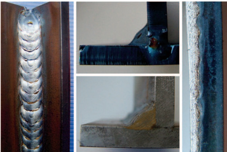
▲ Bild 1. Die Anwendungsstudie für die neue Verfahrensvariante zeigt eine Schweißnaht mit hoher Qualität (Stahl S235JR, Blechdicke 5 mm, Schutzgas 82% Ar + 18% CO 2 , Drahtelektrode G3Si1 mit 1 mm Durchmesser, Drahtfördergeschwindigkeit 4,4 m/min, Schweißgeschwindigkeit 20,3 cm/min, Schweißstrom 108 A, Schweißspannung 18,2 V, Streckenenergie 7 kJ/cm).
