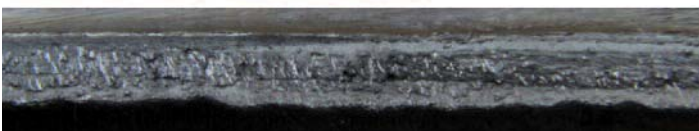
1,2 mm Union RV 71 (Böhler), 8,6 m/min, 260 A/27 V, 82 % Ar + 18 % CO 2 , t = 8 mm S235JR
