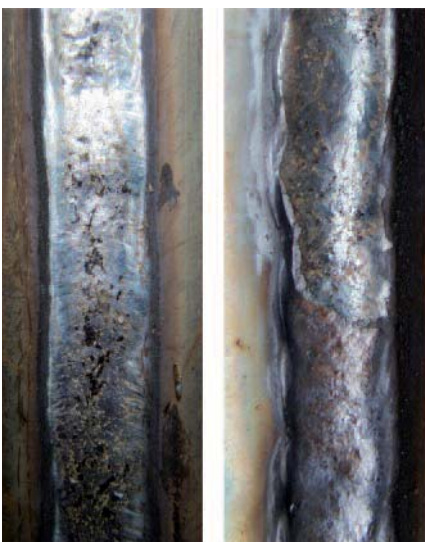
1,2 mm Union RV 71 (Böhler), 8,6 m/min, 260 A/27 V, 82 % Ar + 18 % CO 2 , t = 8 mm S235JR
