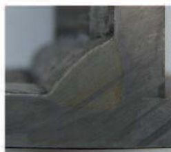
1,2 mm Union RV 71 (Böhler), 8,6 m/min, 260 A/27 V, 82 % Ar + 18 % CO 2 , t = 8 mm S235JR
