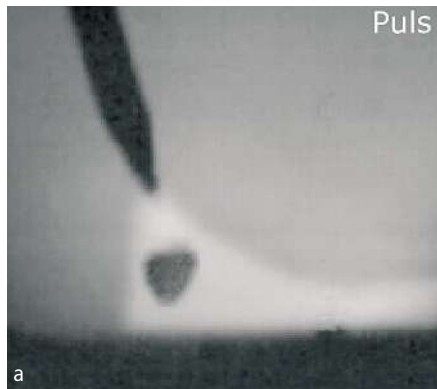
Bild 3: High-Speed-Kameraaufnahmen vom Puls- (a) und Speed-Pulse-Schweißen (b). Das Speed-Pulse-Verfahren bewirkt einen nahezu kontinuierlichen, zugleich aber nach wie vor gepulsten Materialtransfer ins Werkstück.
