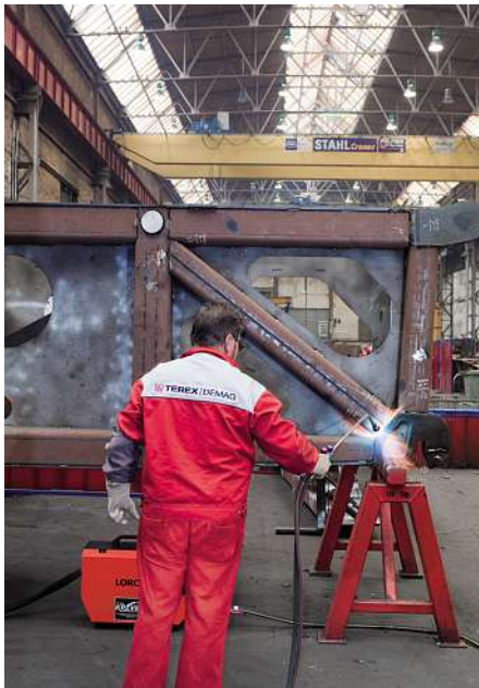
Bild 1: Bei Feinkornbaustählen ist die Einhaltung der richtigen Vorwärmtemperatur besonders wichtig.
